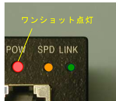
トリガ入力に呼応してLEDが赤色点灯
